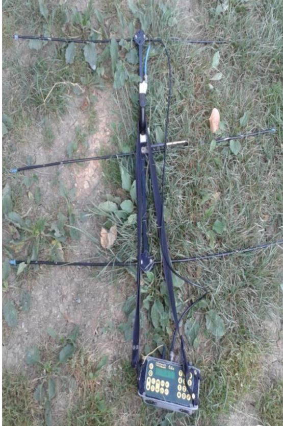
**Fig. 12** : Photographie personnelle de l'antenne Yagi et du boîtier Biotrack
